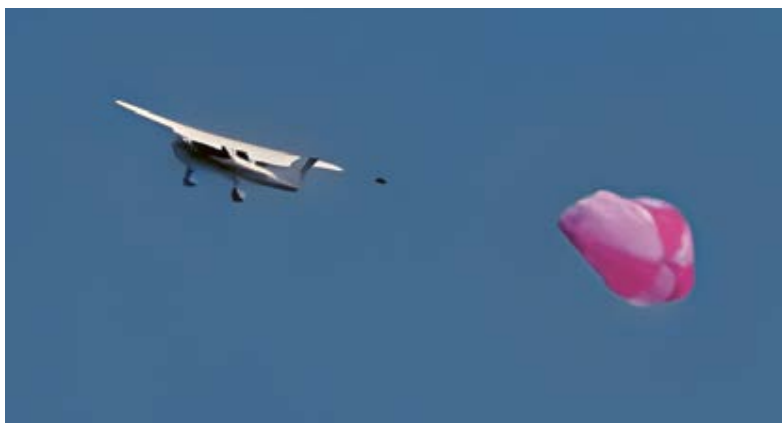
Záchrana letadla s poškozeným podvozkem. ZS byl spolehlivě použit nad letištěm s čekajícími záchrannými složkami, které nakonec nebyly potřeba
