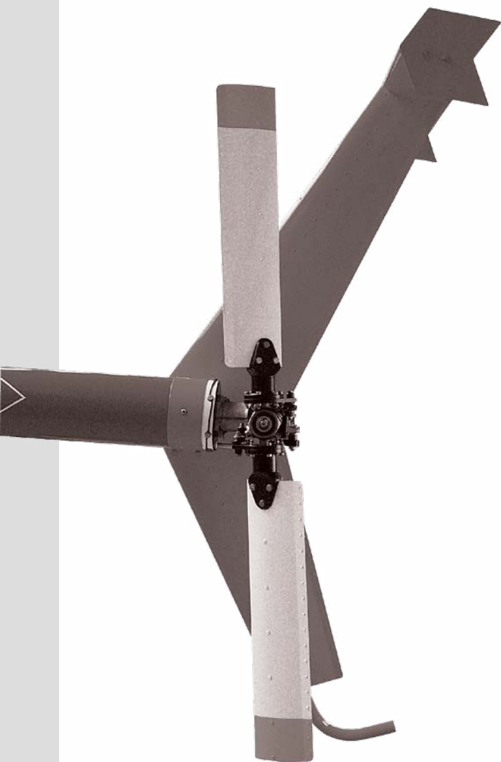
Vyrovnávací rotor s listy provedení „M“ o délce 450 mm – tzv. „horské“ provedení
